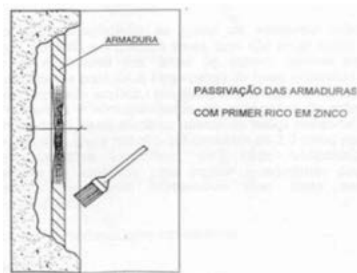
Ilustração do procedimento de passivação das armaduras com primer rico em zinco. FONTE: Falcão Bauer.
