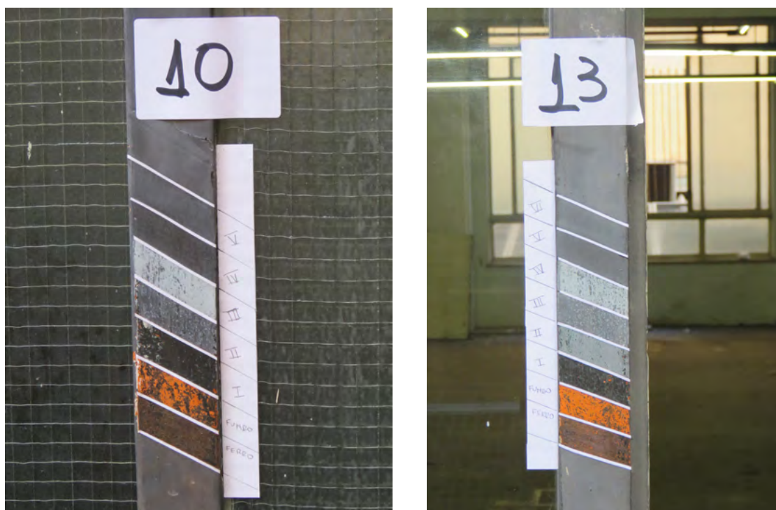
fig 142. Prospecções pictóricas das faces externas dos caixilhos. Fonte: KRM Restaurações, 2022.
