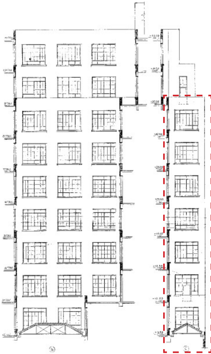
fig 186. Desenho de fachadas do projeto original, constando esquadrias distintas das existentes. Fonte: Acervo FAUUSP.
